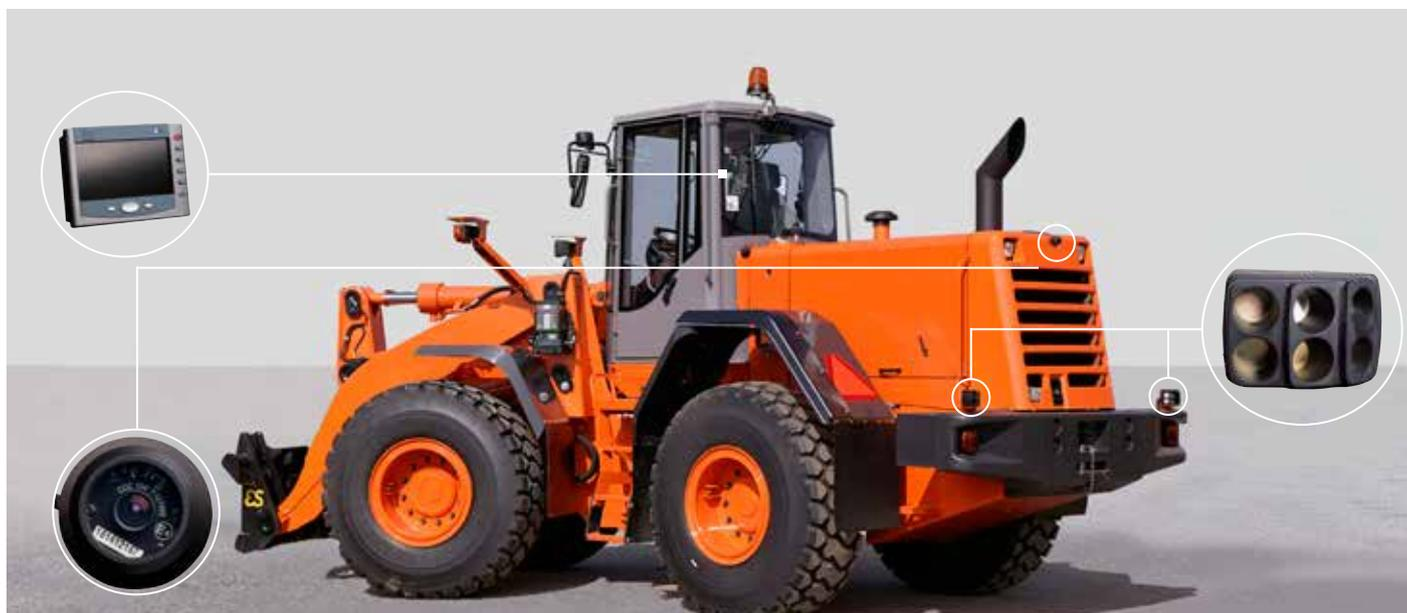
A combinação de sensores e câmara(s) fornece ao condutor informações de segurança ativa e passiva sobre o espaço livre nas imediações da máquina.
